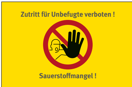
Abb. 3 Beispiel einer Kennzeichnung am Zugang zu einem sauerstoffreduzierten Bereich im Alarmfall - Leuchttabelleau
